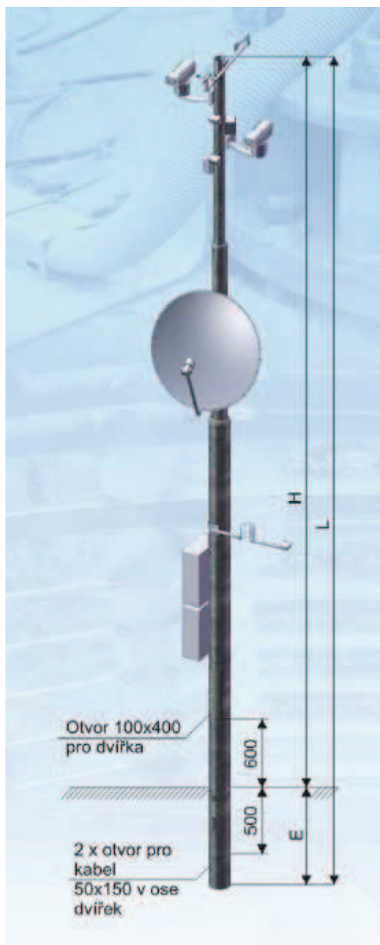
Obr.: Schématický tvar telekomunikačního stožáru
